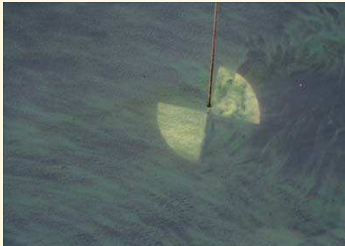
Figure J : Immersion du disque de Secchi. (Photo Luc Briant, Université Rennes 1).
