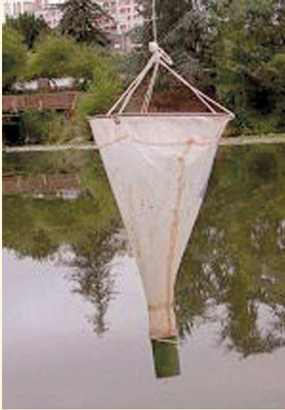
Figure I : Dispositifs de prélèvement utilisés depuis la berge (de gauche à droite ci-dessous, filet à plancton et tube échantillonneur) ou depuis un bateau (en bas à gauche, bouteille de prélèvement de Van Dorn). (Photos Maria Leitao, Bi-Eau).
